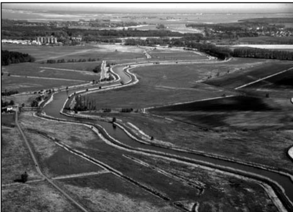
Taf. 3c: Barthelauf zwischen Divitz und Barth, Blick von Süden (Schrägluftaufnahme). Der Fluß ist ausgebaut und eingedeicht.
