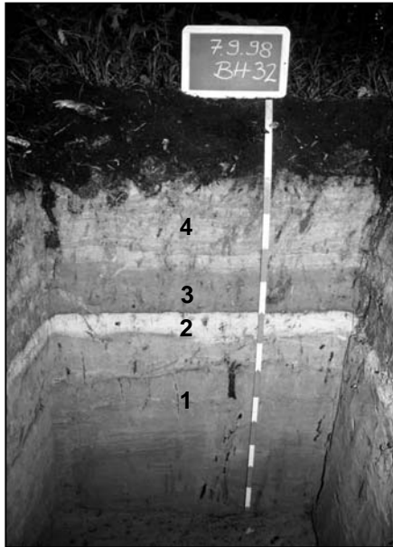
Taf. 5a: Profil Barther Heide 32, 1 = glazilimnischer Sand, 2 = Kalkmudde des Alleröds, 3 = Silikatmudde der Dryas-III, 4 = limnischer Sand der Dryas-III.
