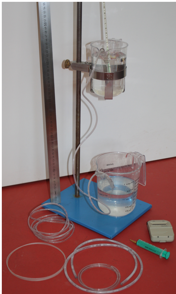
Abb. 5: Geräte zur Versuchsdurchführung: Stativ mit oberen und unteren Messbecher, diverse Schläuche, Ansaugspritze, Stoppuhr und Stahllineal.
