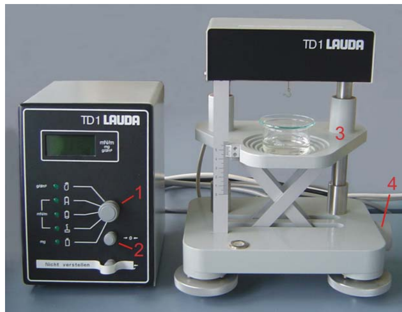
Abb. 5 Frontansicht des TD 1E und Ansicht des TD 1M, 1 - Messartschalter, 2 - Tarierungspotentiometer, 3 - Messtisch mit Messbecher, 4 - Drehknopf für die manuelle Bedienung.
