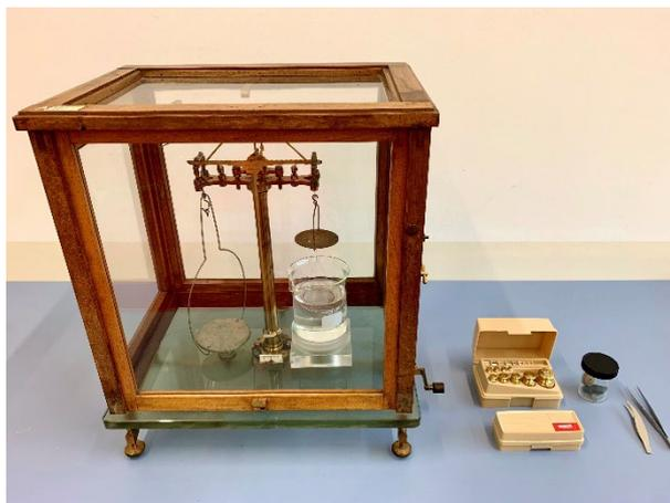
**Abb. 4** Experimentelle Anordnung der Hydrostatischen Waage.
