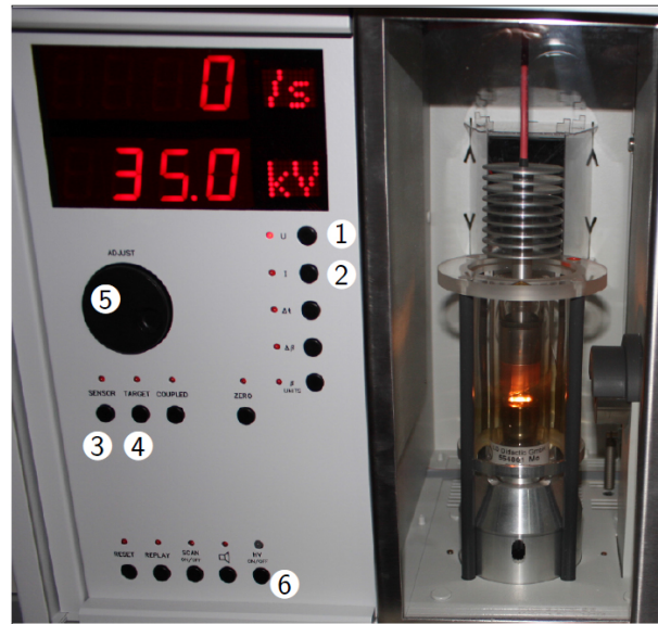
Abb. 7: Bedientableau des Röntengerätes: (1) Auswahltaster für Beschleunigungsspannung, (2) Auswahltaster für Stromstärke, (3) Auswahltaster für Winkel Detektor, (4) Auswahltaster für Winkel Targettisch, (5) Einstellrad, (6) Ein/Aus-Taster für Hochspannung U der Röntgenröhre.
