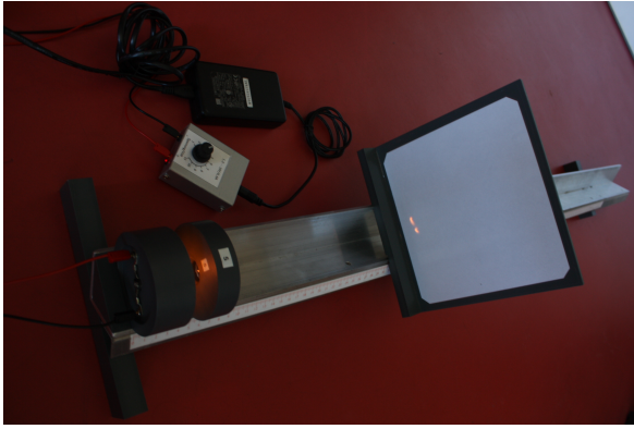
Abb. 12: Versuchsaufbau zur Messaufgabe 3: Brennweite von Sammellinsen.
