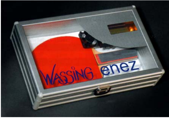
Abbildung 7: Testgerät (Prototyp) zur Überprüfung eines Tischtennisschlägers auf verbotene VOCs (Wassing Messtechnik, DTTB)
